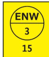
Erläuterung: Kennzeichen einer Prüfstelle für Elektrizitätsmessgeräte (E), zuständige Behörde Nordrhein-Westfalen (NW), zugeteilte Ordnungsnummer „3“, Jahr der Eichung 2015.
